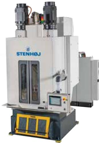
Das universelle Hebetisch-Modell zum Weich- und Harträumen in gehärtete Werkstücke ist ein äußerst wettbewerbsfähiges und kompaktes Modell und unsere beliebteste Räummaschine.
